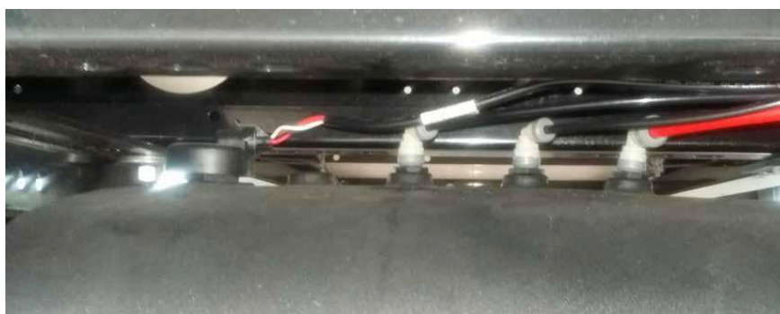
Sensore capacitivo ad asta con indicazione livello serbatoio tramite servizi telematica oppure con display a LED
