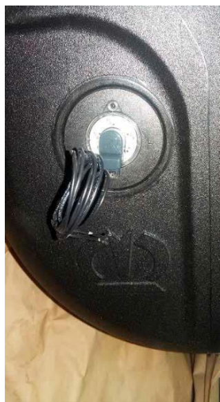
In futuro verrà eliminato: Indicatore di livello elettrico con galleggiante di serie e display al paracabina
