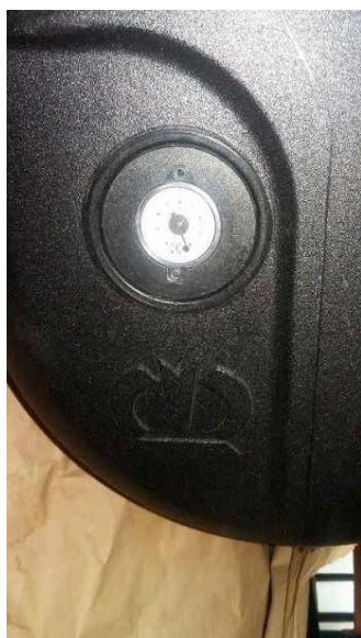
Indicatore di livello analogico (di serie) al nuovo serbatoio Diesel
