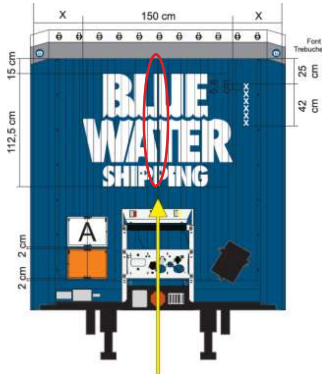
Immagine 2: rappresentazione futura nella bozza delle scritte: in corrispondenza della linea di saldatura la scritta risulta "mancante"!
