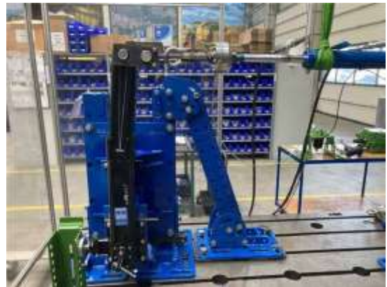
Fig. 3: Configurazione di prova per le forze longitudinali
